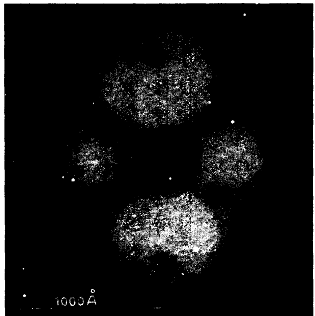
Abb. 6: Bild einer reinen Wolfram-Einkristallspitze. Die hellen und dunklen Flächen rühren von den verschiedenen Ablösearbeiten der Elektronen her. Ein aufschlußreicher Blick in die Kristallstruktur
